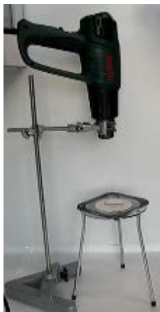
Figur 3. TiO 2 -filmen hærdes ved 450-500 °C i 30 min under en varmpistol.
