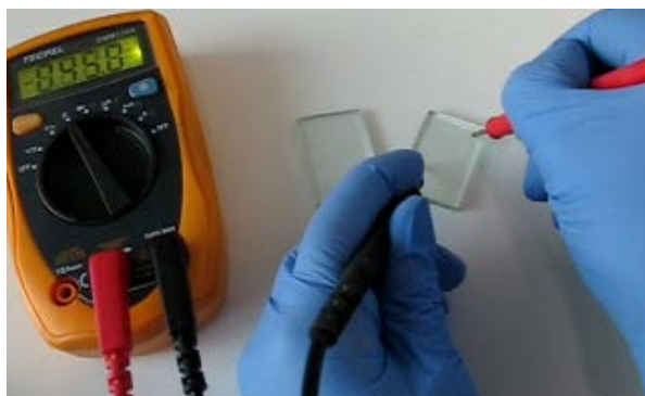
Figur 1. Den ledende side af glasset findes ved at måle modstanden hen over glasset vha. et multimeter og to prøveledninger.
