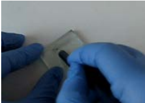
Figur 5. Fremstilling af modelektrode: Et arafit laa påføres alassets ledende side.
