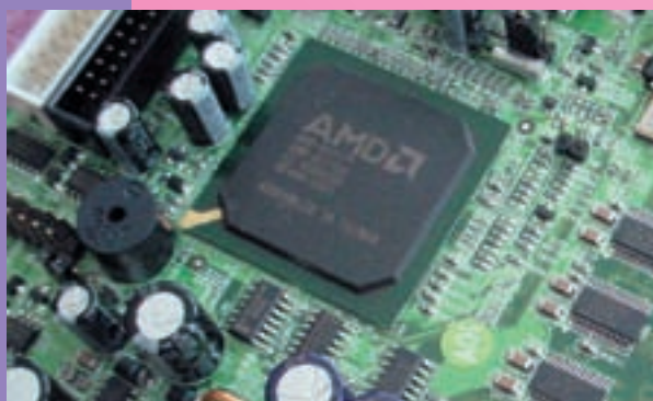
Integrerede kredsløb: et typisk motherboard i en computer, med processoren i centrum. På et par cm er der tusindvis af elektroniske komponenter, der hver kan udføre en enkelt opgave.
