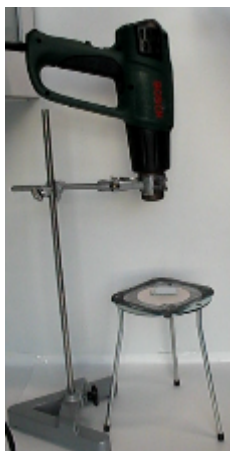
Figur 4. TiO 2 -filmen hærdes ved 450 °C i 30 min under en varmepistol.
