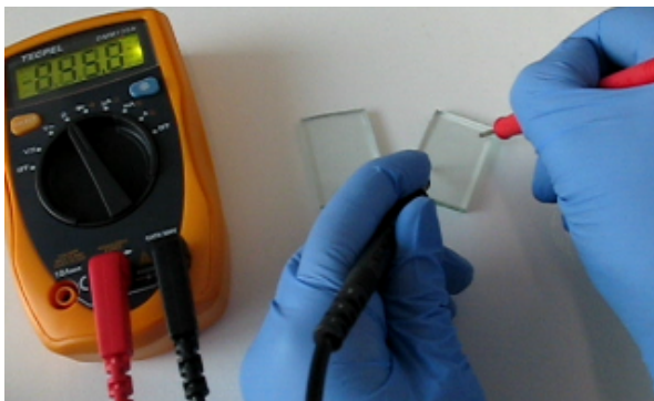
Figur 2. Den ledende side af glasset findes ved at måle modstanden hen over glasset vha. et multimeter og to prøveledninger.
