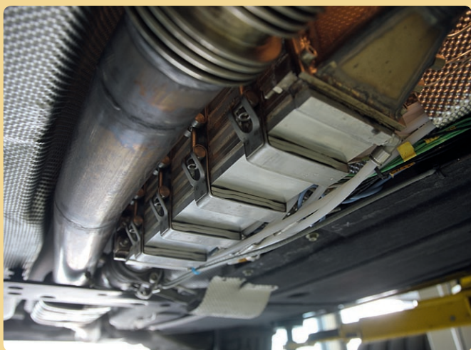
Model og foto af BMW-motor med thermo-elektriske materialer
